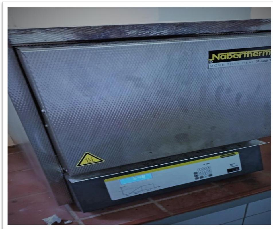
**Figure III.3** : four électrique à moufle
