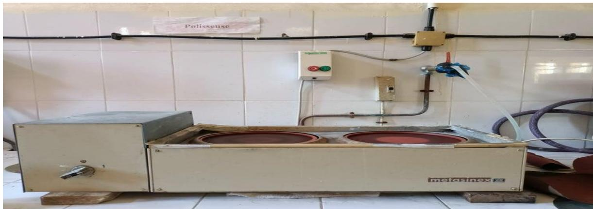
**Figure III.6** : polisseuse mécanique
