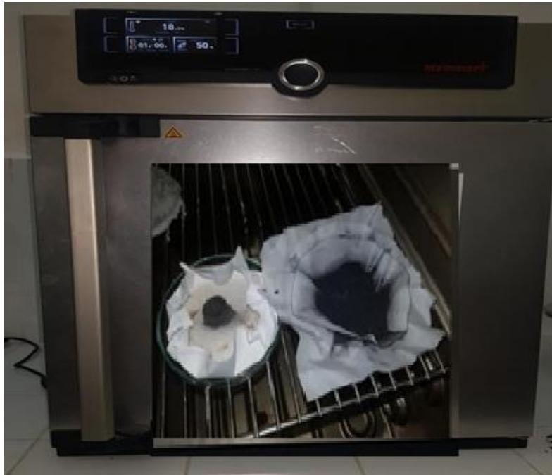
Figure II. 17: les échantillons filtrés dans l'étuve MEMMERT
