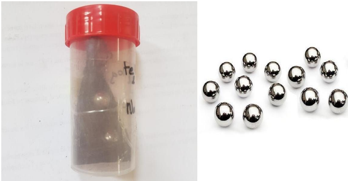
Figure II.4: poudre homogénéisée avec des billes.
