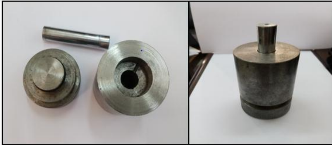
Figure II.5: Dispositif de compactage des poudres.
