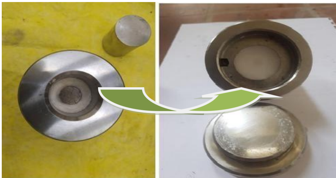
Figure II.8 : Montre la pastille entourée par le sel KCl ( Chlorure de potassium ).
