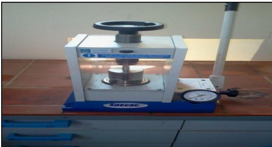
Figure II.6: Pastilleuse de laboratoire SPECAC, capacité maximale 25 tonnes.
