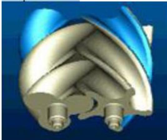
**Figure 2.4 :** Phase d'aspiration des gaz dans un compresseur à vis.
