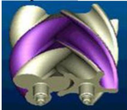
**Figure 2.5 :** Phase de compression des gaz dans un compresseur à vis.
