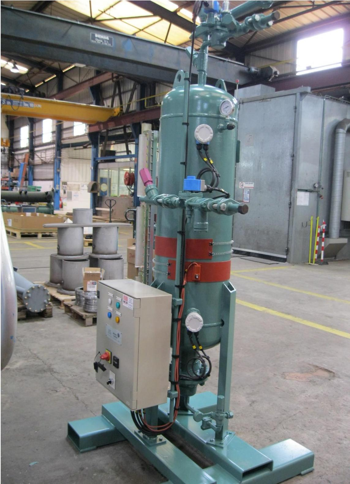
**Figure 3.19** : Une vue réelle de droite d'un filtre déshydrateur de type WDO.
