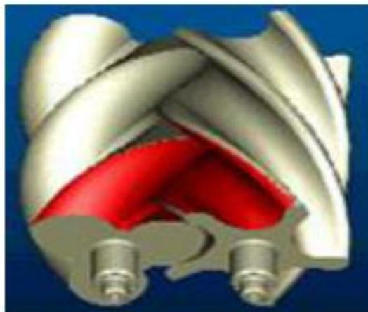
**Figure 2.6 :** Phase de refoulement des gaz dans un compresseur à vis.
