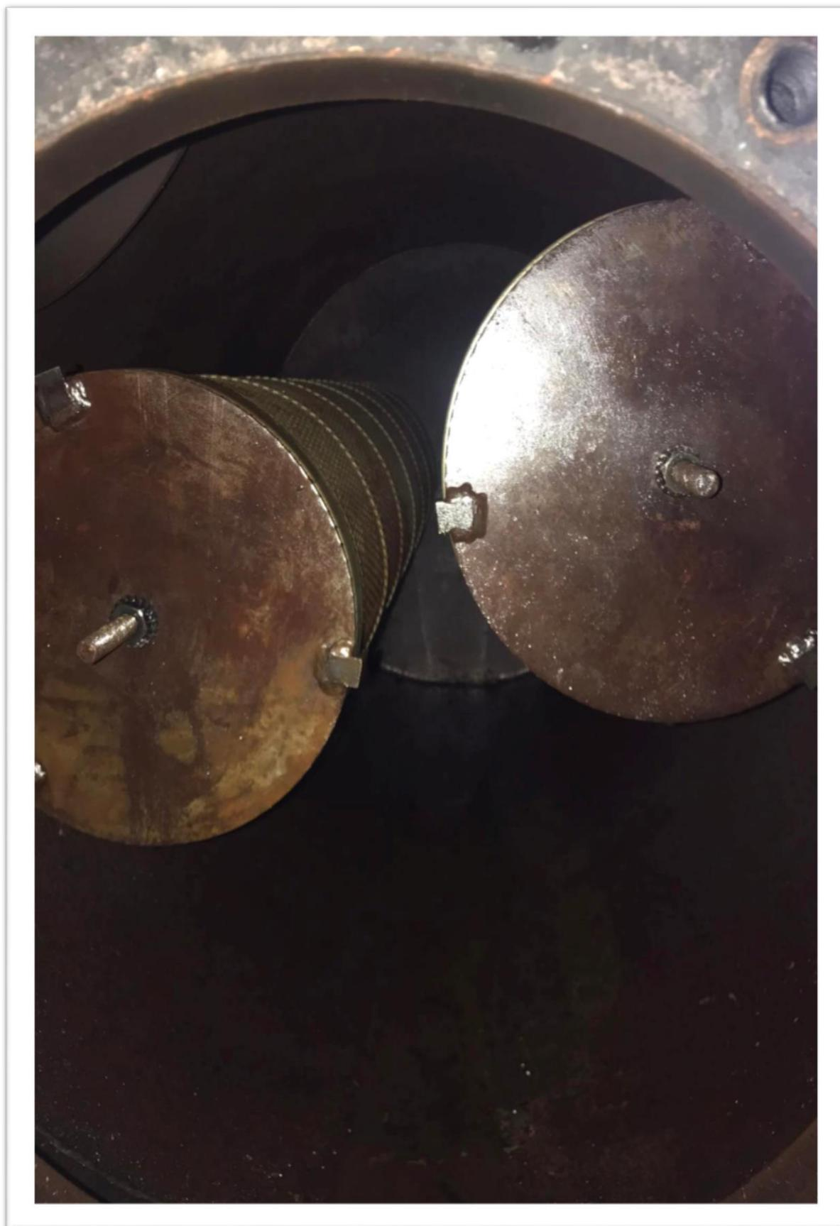
**Figure 3.21** : L'emplacement des filtres coalesceurs ancien modèle au niveau de séparateur d'huile (une vue réelle).
