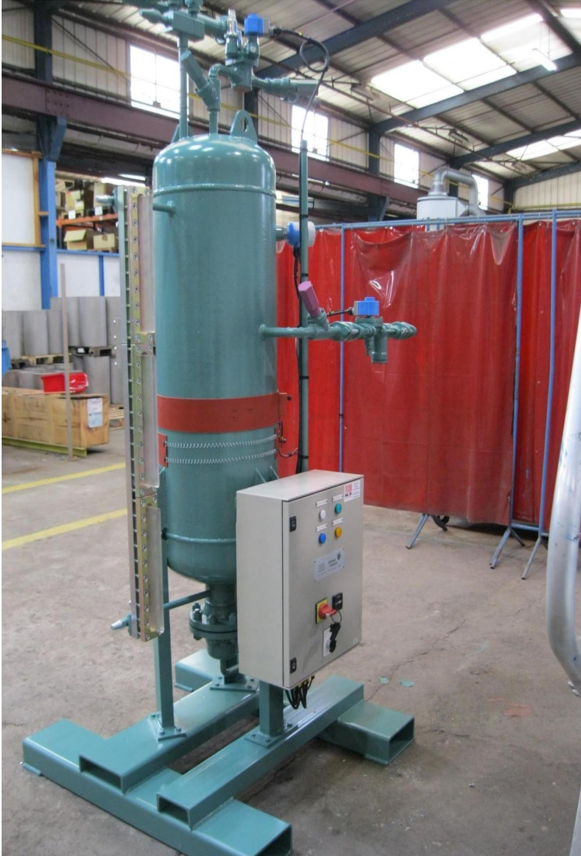
**Figure 3.18** : Une vue réelle de gauche d'un filtre déshydrateur de type WDO.
