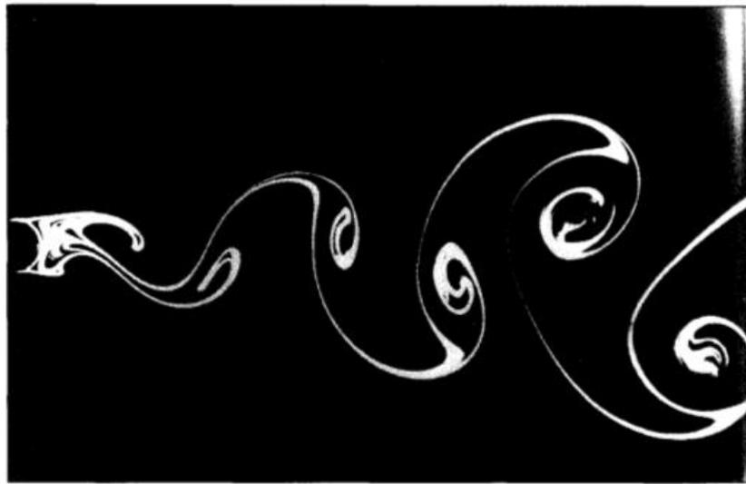
Figure 2.5 : Allée de Von Karman derrière un cylindre où  $Re = 140$  [10].
