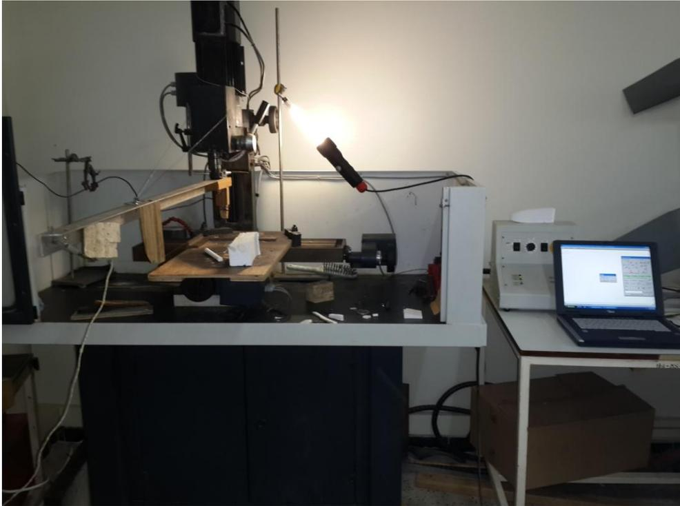
Figure 3.2 : Machine de découpe numérique par fil chaud.
