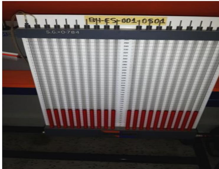
Figure 3.5 : Instrument de mesure des pressions.
