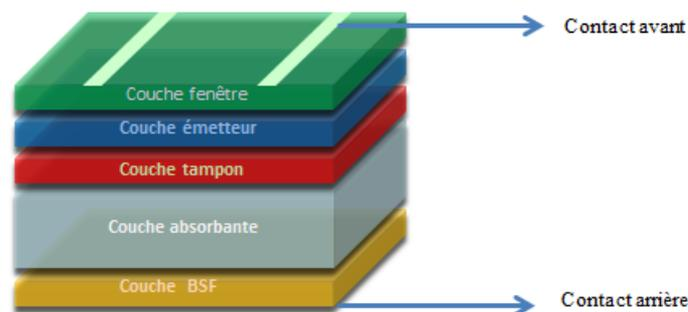
*Figure I.5 Structure standard d'une cellule solaire a hétérojonction en couche minces.*
