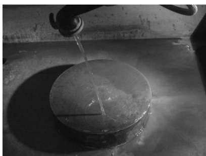
b- Nettoyage de l'excédent de pénétrant par lavage
