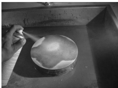
b- Nettoyage de l'excédent de pénétrant par lavage
