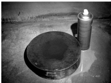
a- Application du liquide pénétrant
