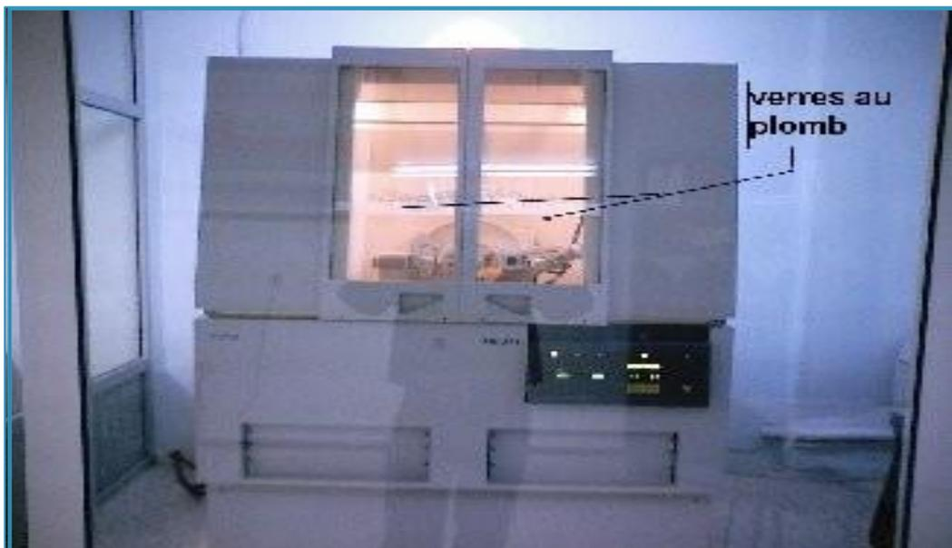
**Figure (II.17)** : Photographie du diffractomètre de type Philips X'Pert Pro en configuration de Bragg-Brenta
