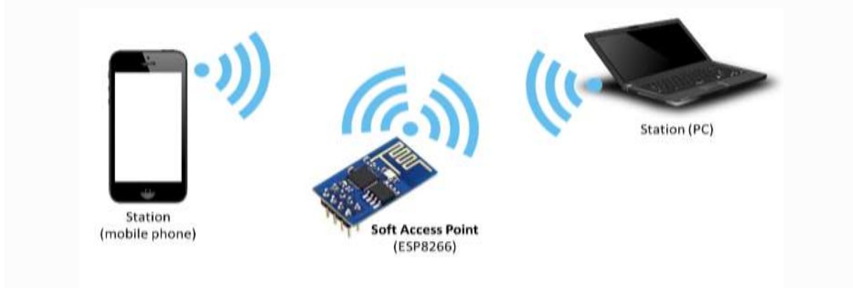
Figure 3.32 : ESP8266 en mode point d'accès [12].
