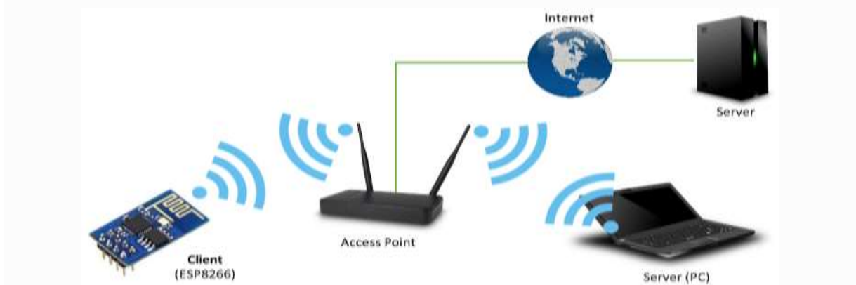
Figure 3.33 : ESP8266 en mode client [12].
