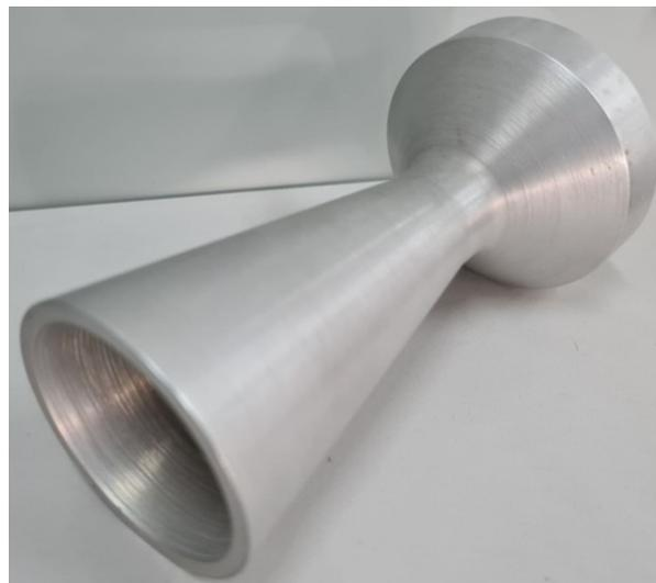
**Figure (3-23) : Tuyère conique expérimental**
