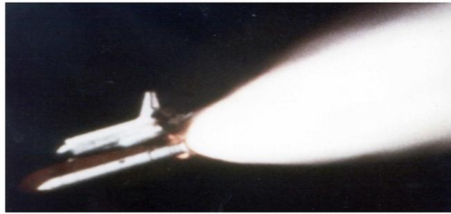
Figure (2-11.b) Éclatement des jets des boosters de la Navette Spatiale à haute altitude [13]
