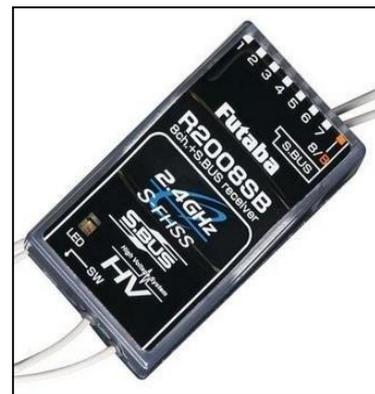
**Figure III-13 :** Récepteur Futaba RS2008SB.
