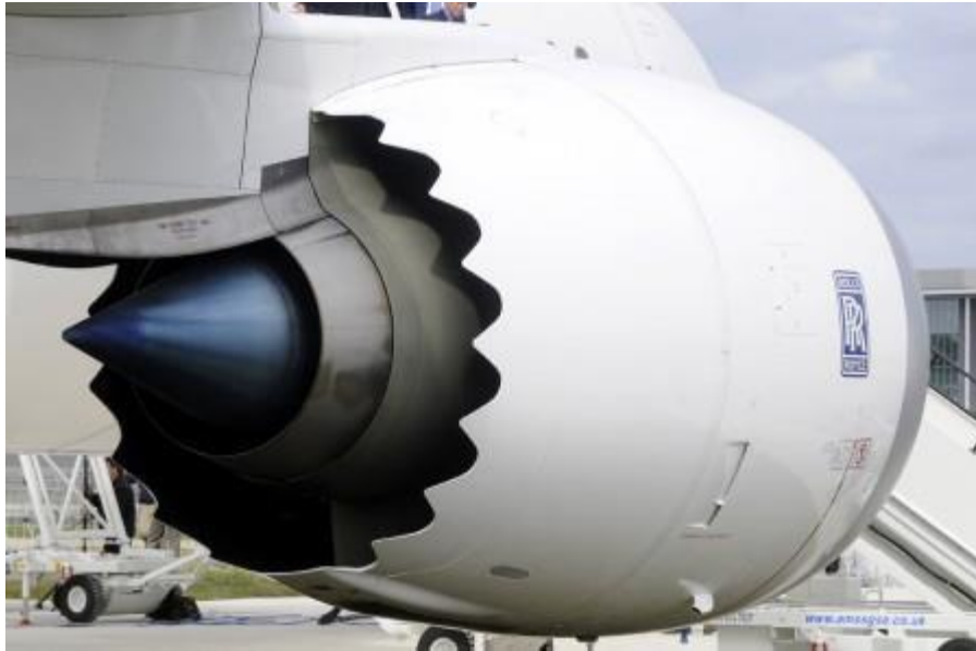
Figure I-12: Tuyère à chevrons
