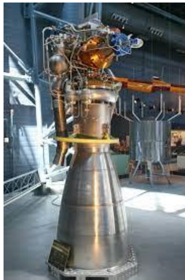
Figure I-1 : tuyère da Laval
