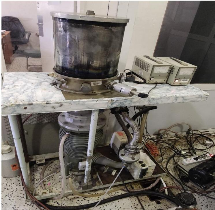
**Figure II 16** : Équipement utilisé pour la technique PVD.
