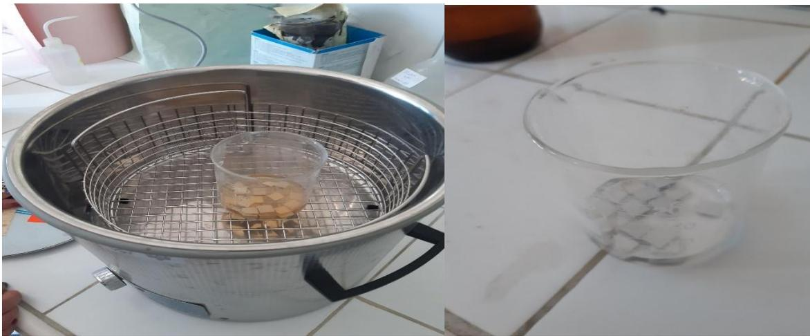
**Figure II 15** : Nettoyeur à ultrasons de type BIOBLOCK SCIENTIFIC et Becher avec les substrats.
