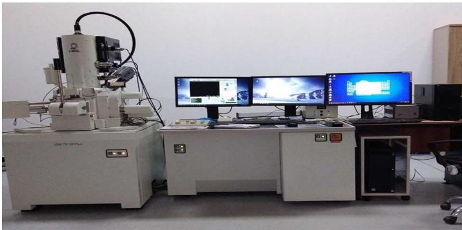
**Figure II 11** : Microscope Electronique à Balayage de haute résolution (MEB) JSM-7610FPlus
