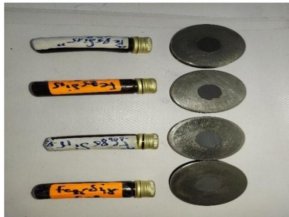
Figure II 9 : Placement de poudre sur les ports échantillons.
