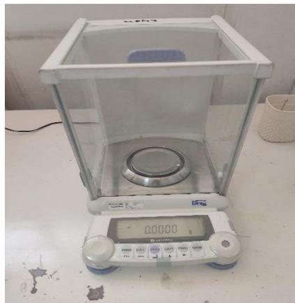
**Figure II 6** : balance électronique.
