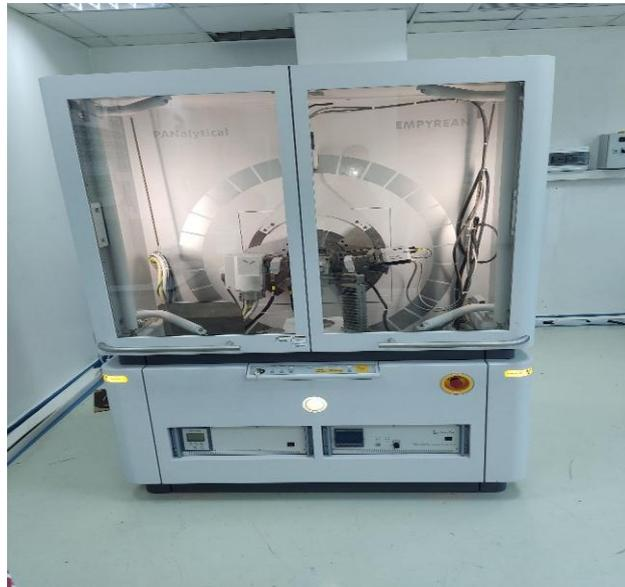
Figure II 8 : Diffractomètre des rayons X de type panalytical empyrean.
