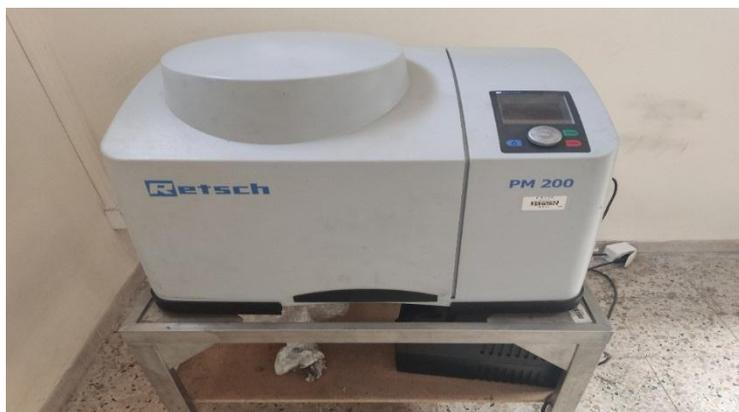
**Figure II 2** : Broyeur planétaire de type (retsch PM200)
