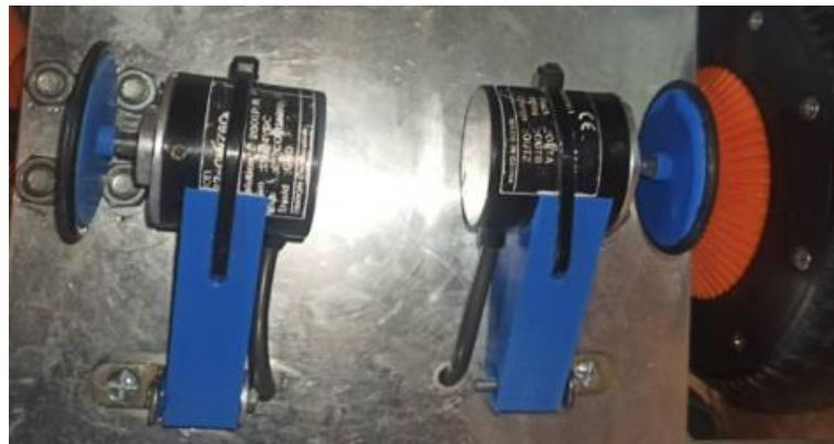
Figure 2:18 : L'emplacement finale des encodeurs liés aux roues codeuses sur le châssis
