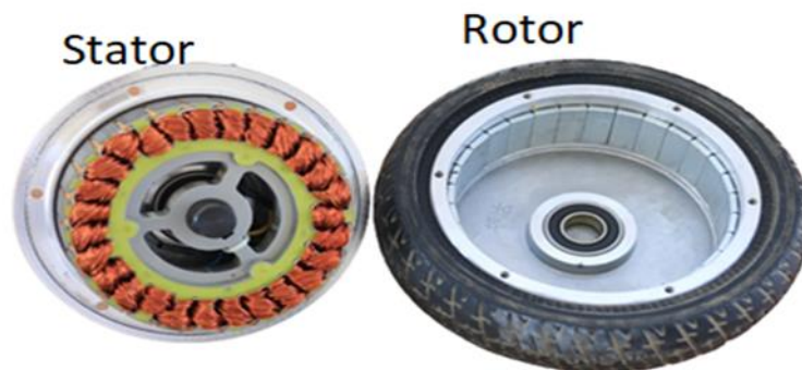
Figure 2:5 : La composition d'un moteur Brushless.
