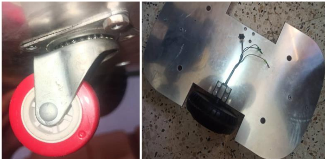
Figure 2:14 : Les roues utilisées : à gauche la roue folle, et à droite le châssis avec la roue motorisée.
