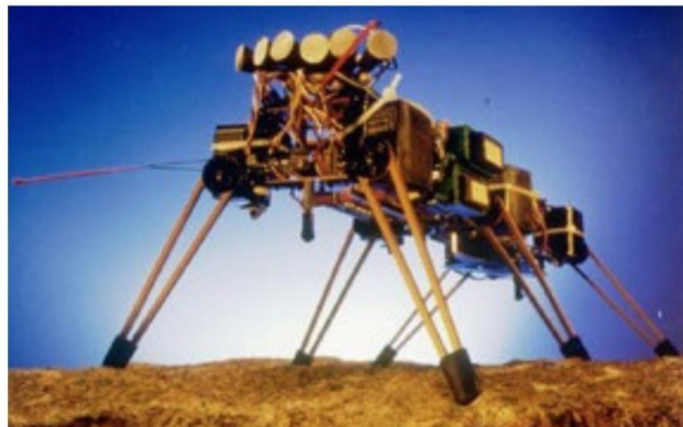
Figure 1:5 : Genghis, développé par Rodney Brooks au MIT au début des années 1990 [3].
