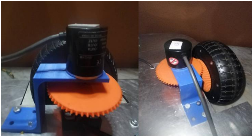
Figure 2:16 : Le placement final de l'encodeur sur le châssis.
