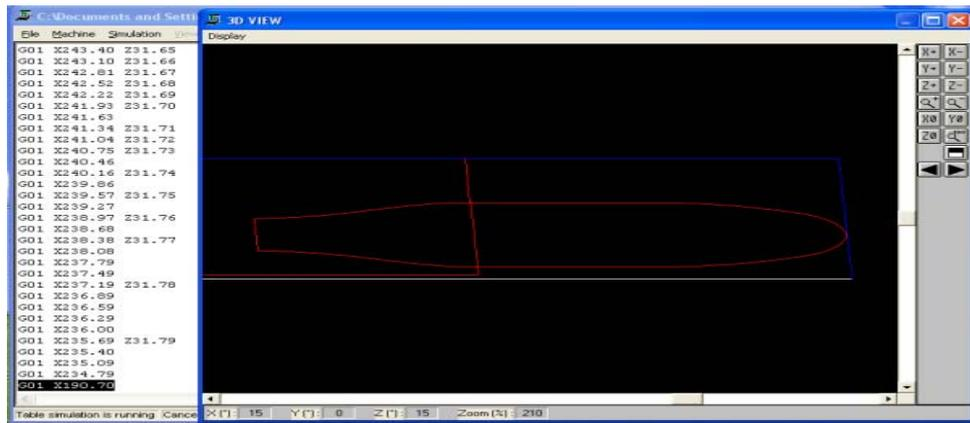
Figure (3.16).Simulation de découpe sur nccad7 (dessus)
