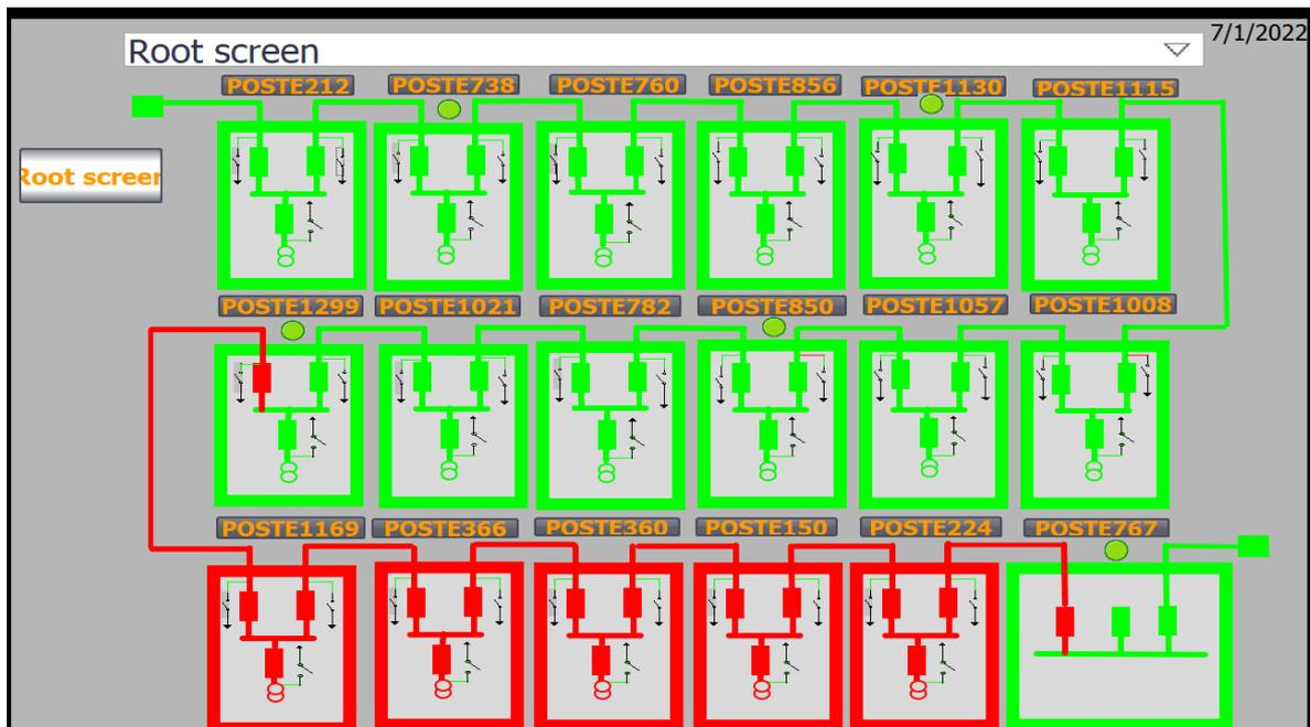
Figure 3.32: Vue départs et postes d'isolation et de réalimentation d'un réseau 30kv
