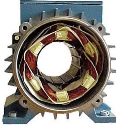
*Figure 2.2.* Stator d'une MAS avec bobinage.
