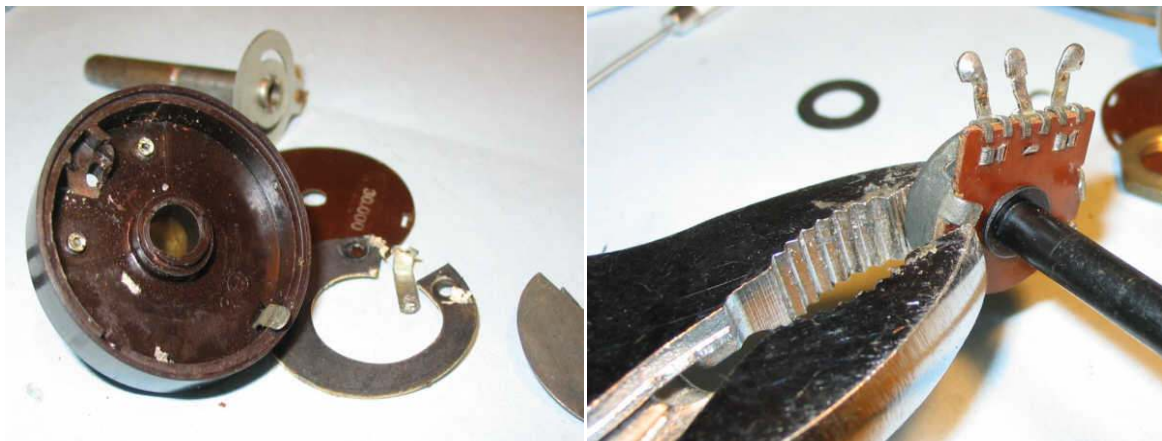
FigIII.3.1.4.b image élevé l'obstacle pour que le potentiomètre tourne libre 360^\circ
