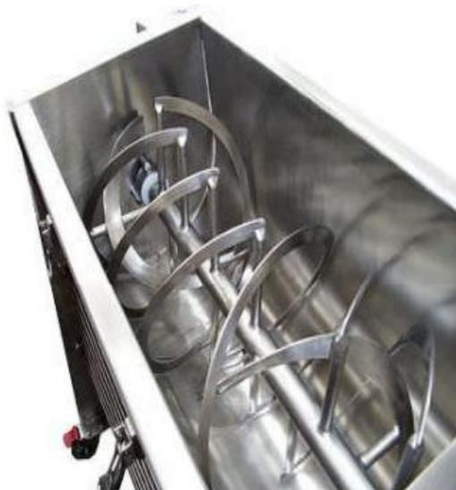
**Figure I.8 :** Mélangeuse horizontale
