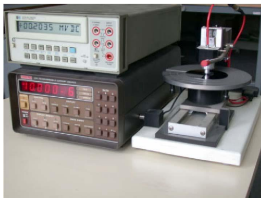
Figure II.10. Dispositif de mesures électriques « 4 pointes ».
