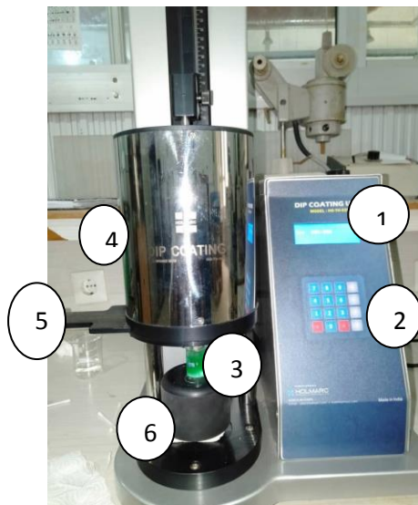
Figure II.13. Dispositif expérimental du Dip-Coating.
