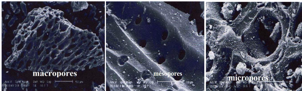
Figure III.1 : Différentes structures du charbon actif vues au microscope électronique à balayage (MEB)
