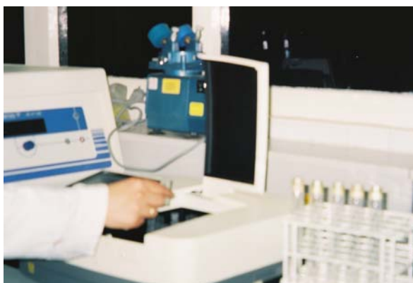
Figure 5.18 : Mesure de D.O. à laide du spectrophotomètre.
