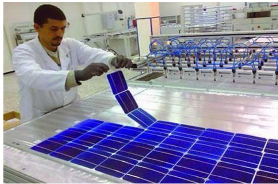
Figure 3.4) : l'assemblage des panneaux photovoltaïque a l'entreprise Condor
