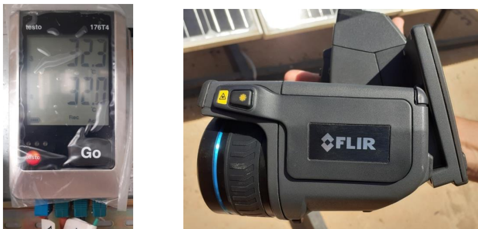
Figure.III.12 : Data-logger et caméra thermique
