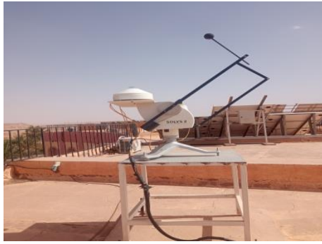
la station radiométrique Solys2
