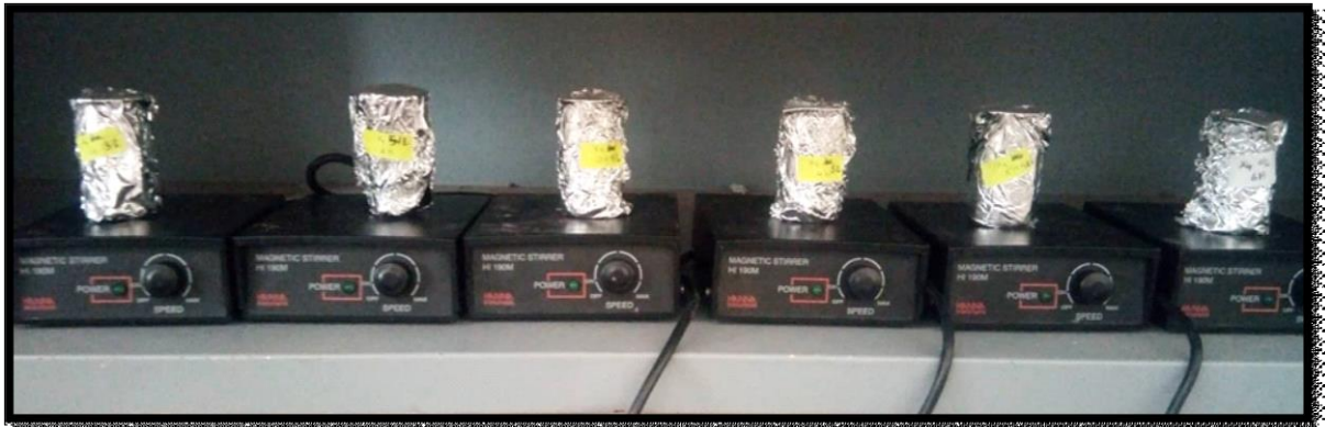
FigureC. 3 : Dispositif Expérimental de dépollution de BM en absence de la lumière du soleil.
