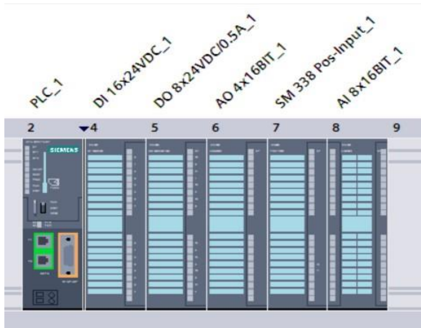
Figure 2.17 -Les différentes composants d'un API de notre projet[17].
