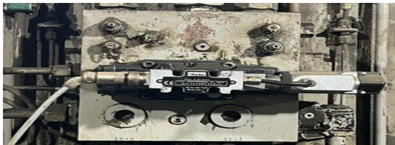
Figure 2.7-Servo-valve de la commande hydraulique de la grille du refroidisseur
