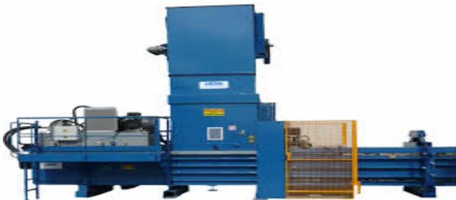
Figure 2.4: Dispositif presse à balle horizontale.
