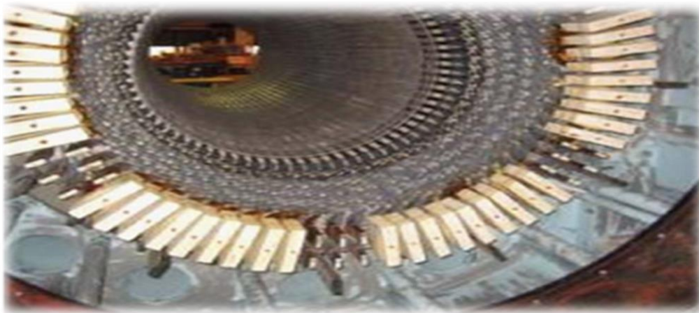
Figure 3-11 : Spires terminales types de l'enroulement du stator et connexions pour un alternateur bipolaire refroidi à l'hydrogène
