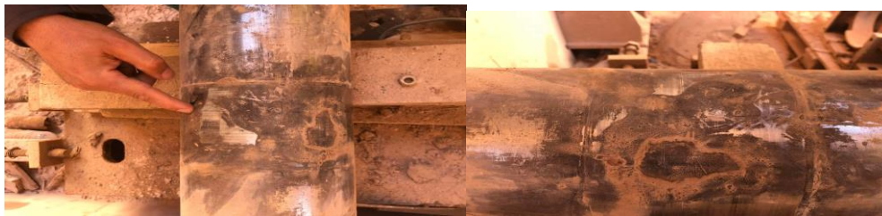
Figure 3.23 : la pâte belzona sur l'arbre.
