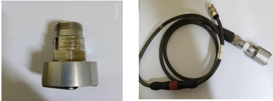
Figure 3.3 accéléromètre de type piézoélectrique.
