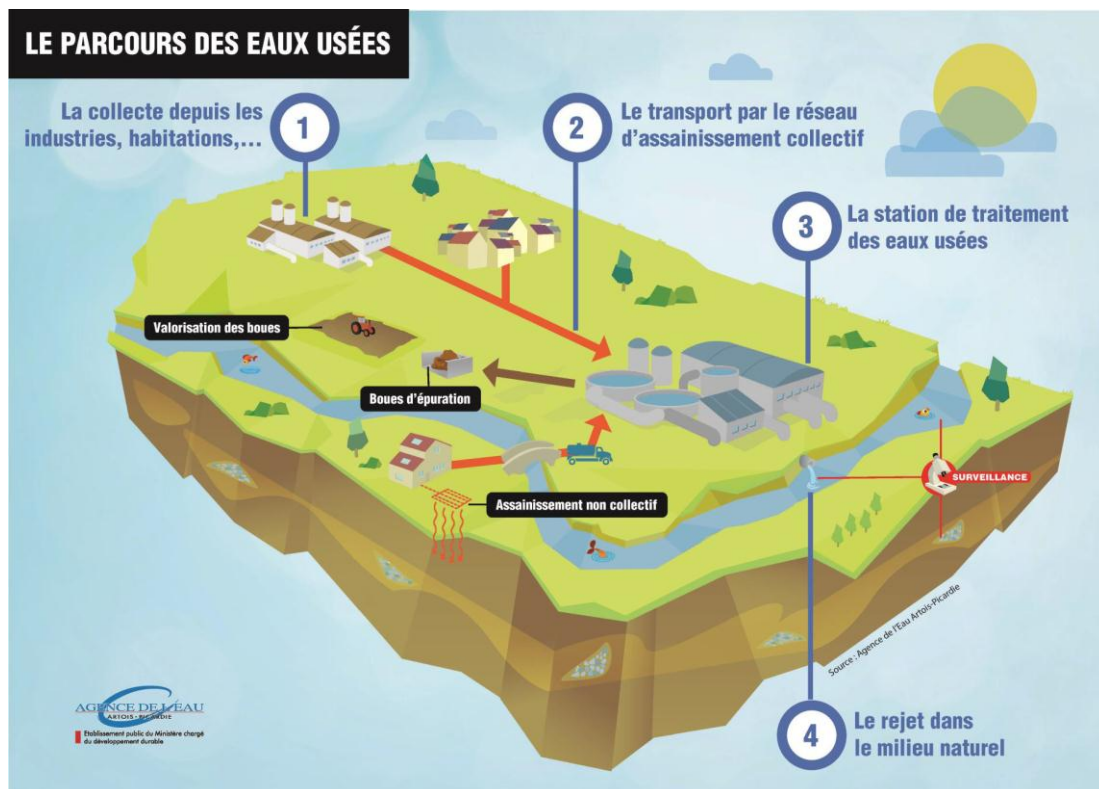
Figure II.1 : Schéma montrant le parcours des eaux usées.
