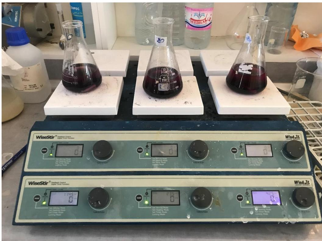
**Figure III. 3 :** Dispositif utilisé pour l'adsorption du rouge solophényl.
