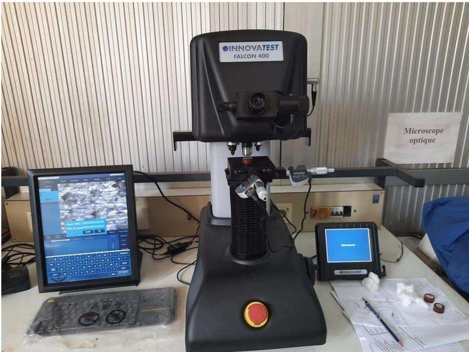
figure 2-6 : le **micro Duro-mètre** utilisée
