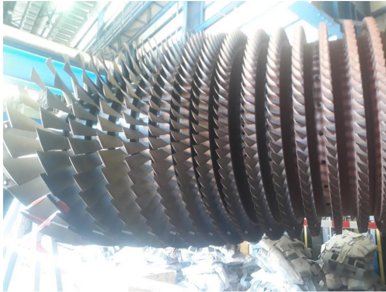
Fig.II. 6: Compresseur (15) étages de la turbine V94.3A.
