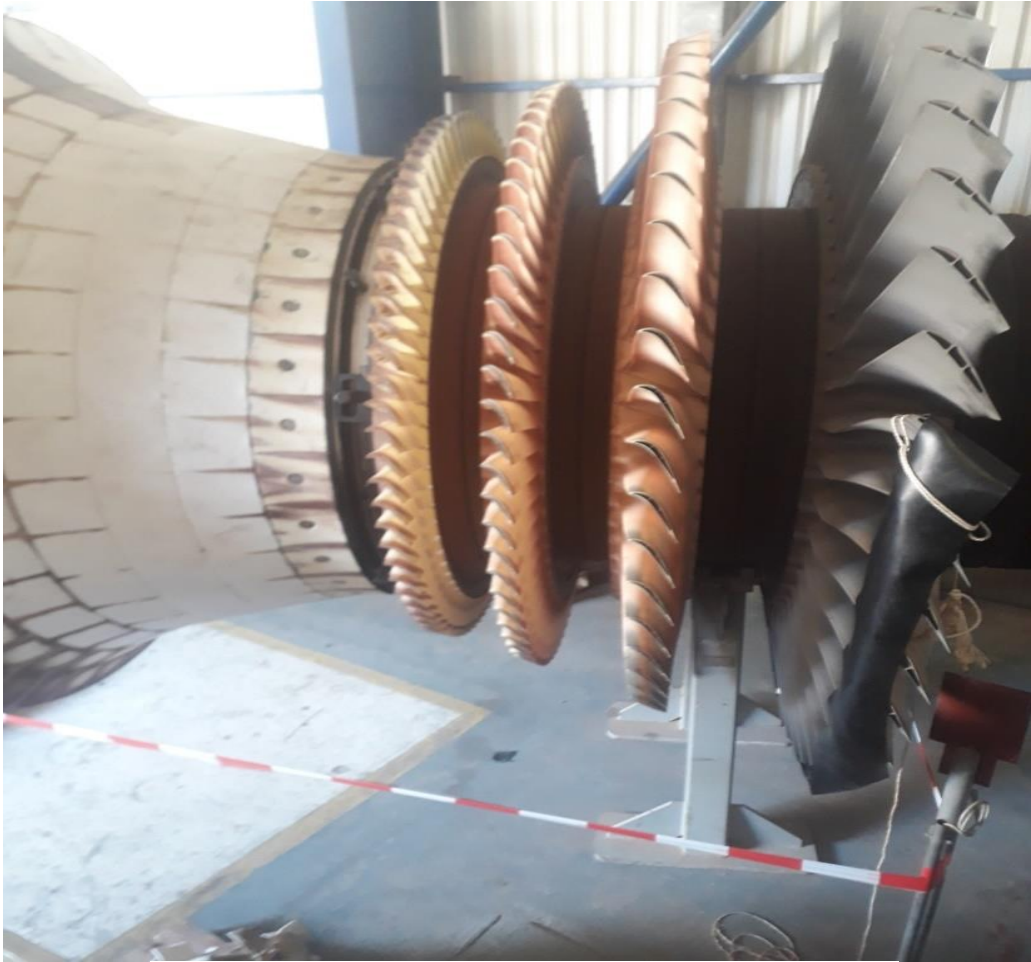
Fig.II. 9: Les 4 étages de la turbine et l'aubage.
