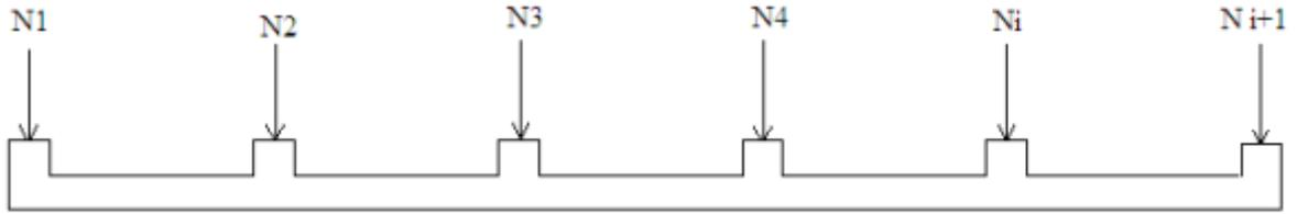
Figure VI .2 : Schéma de la semelle filante.
