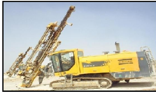
Figure 1.3 : Abattage par sondeuse [1]
