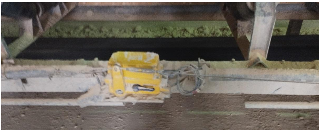
Figure A.2 : câble de sécurité.
