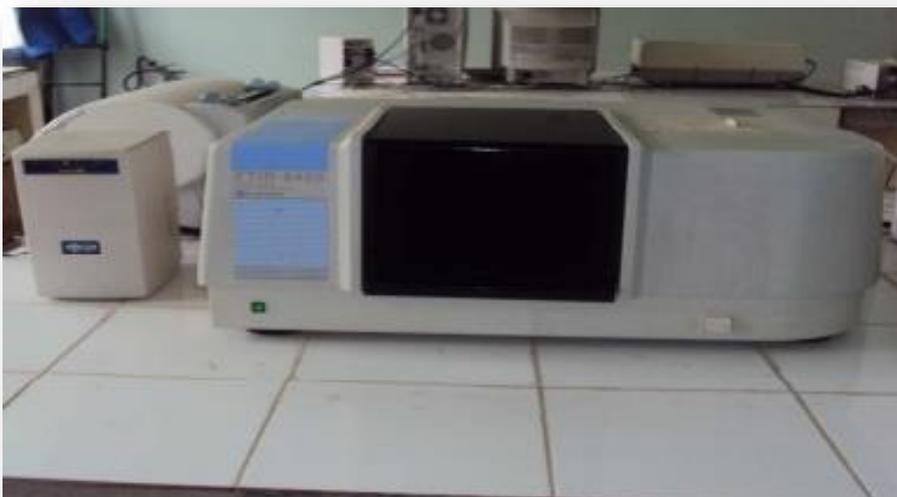
**Figure 2.4.1.2.** Spectromètre FTIR 8400 SHIMADZU
