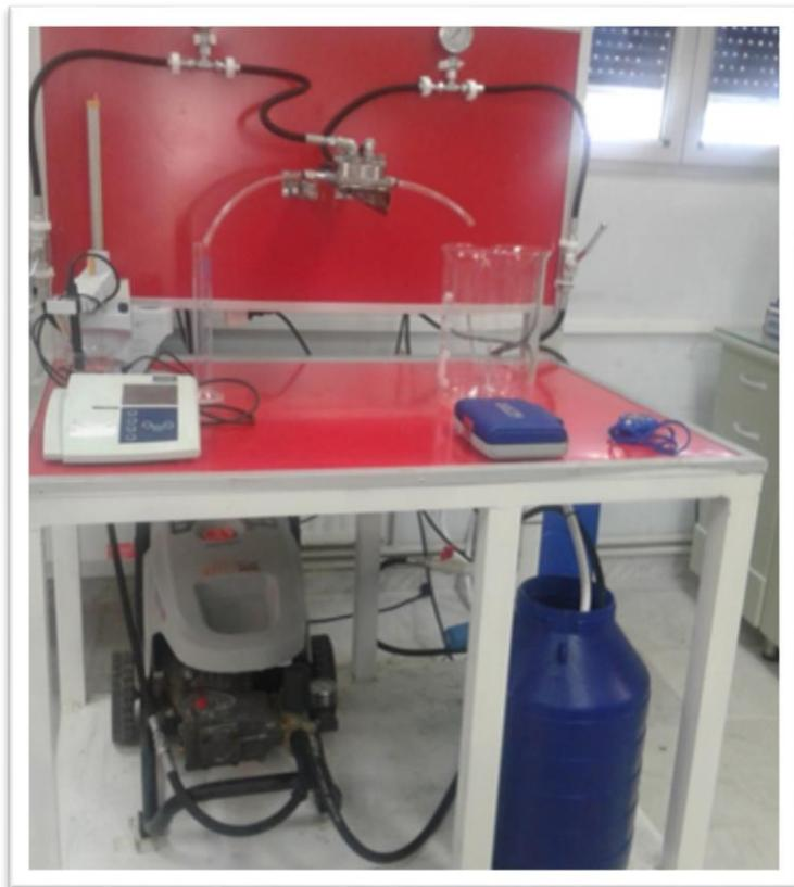
**Figure 2.4.3.**Photos du banc d'essai du système de filtration de membrane conçu à DDESM/UDES
