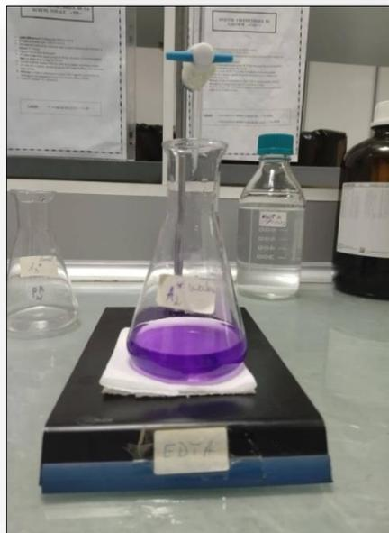
**Figure 2.5.1.** Analyse volumétrique de la dureté totale (TH)
