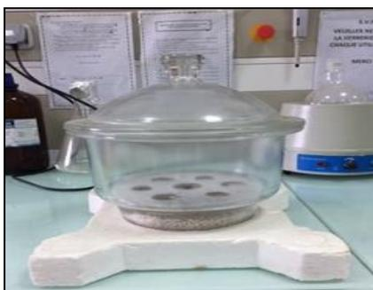
**Figure II.2 :** un dessiccateur à gel de silice granulé (Equipe Dessalement DDESM-UDES)
