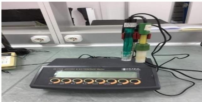
**Figure II.10:** Multi paramètres de paillasse HACH
