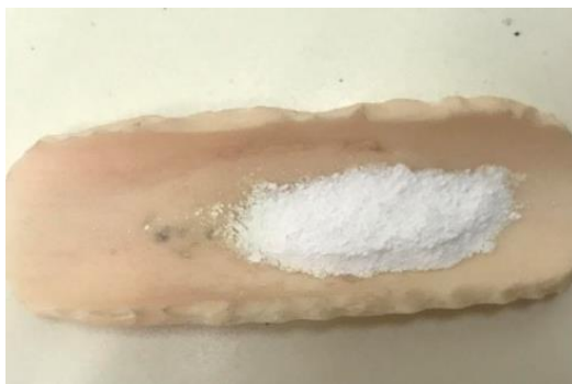
Figure II.3 : la nacelle utilisée dans le laboratoire
