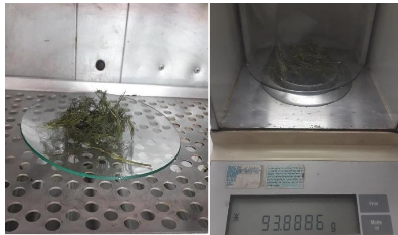
Figure 4.8: Pesée et séchage pour déterminer la perte à la dessiccation
