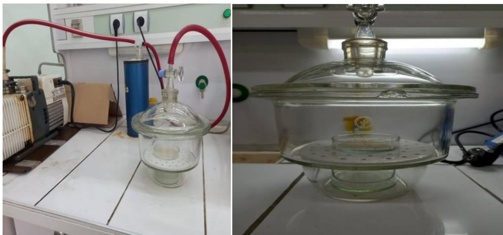
**Figure :** Méthode d'évaporation/adsorption
