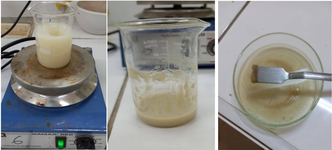
Figure : les étapes de préparation des hybride HE d'origan/Na+MMT
