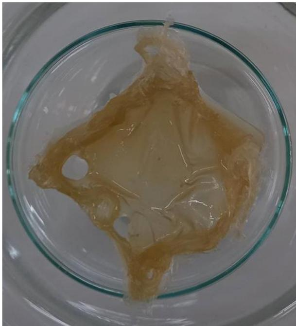
**Figure :** Membrane réservoir composite PVA non réticulé/OMMT/HE
