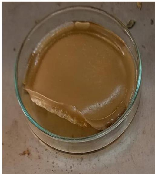
**Figure :** Membrane réservoir composite PVA (non réticulé) / HE/Na+ MMT
