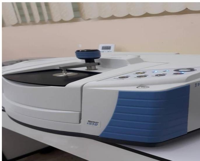
**Figure 3.7** : Spectrophotomètre ATR-IRFT de marque Nicolet is10 FT-IR.
