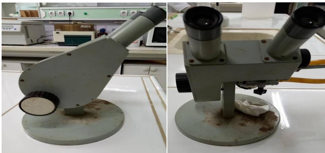
**Figure 3.5 :** Réfractomètre CARL ZEISS JENA.
