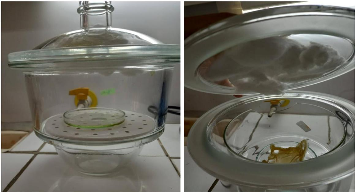
**Figure :** Dessiccateur contient HE et coton dans la partie supérieure
