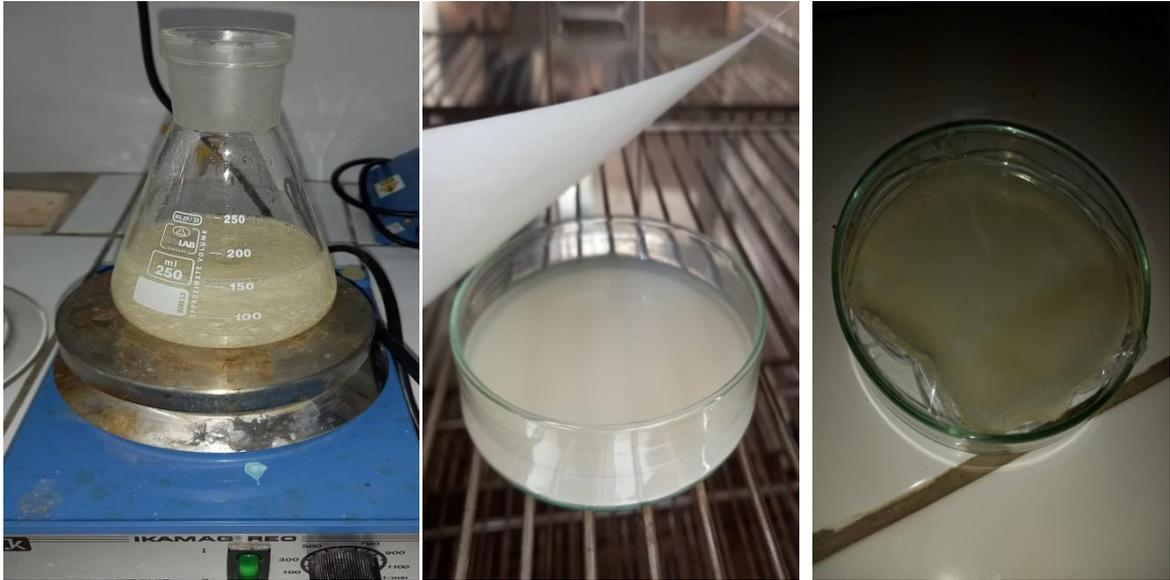
**Figure :** membrane polymérique PVA-(non réticulé)/HE/Na+MMT (méthode évaporation/adsorption)
