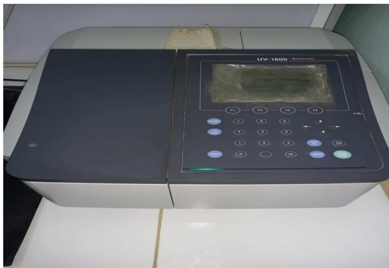
**Figure 3.6:** Spectrophotomètre type SHIMADZU.
