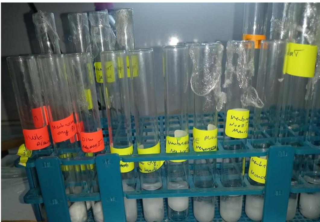
**Figure :** Tubes a essais contenant du : (a) Coton saturé en HE+méthanol, (b) Coton saturé en HE stocké dans la membrane PVA/OMMT composite+méthanol (c) Coton saturé en HE stocké dans la membrane PVA/Na+MMT composite+méthanol
