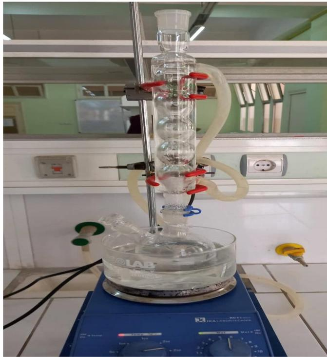
**Figure 3.10** : Solubilisation du PVA par montage a reflux.
