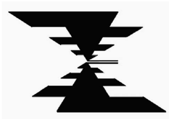
Figure 1.10 : Antenne log-périodique trapézoïdale [10]
