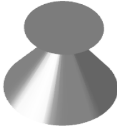
Figure 1.12 : Exemple d'une antenne discône [8]
