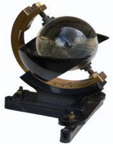
Figure I- 11: héliographe d'après Campb II. Stock [19]
