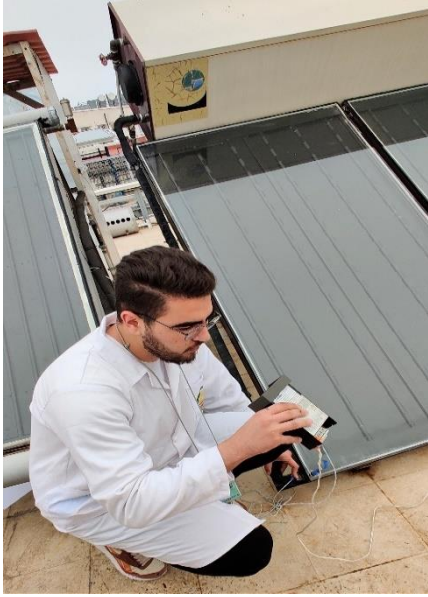
Figure III- 3: mesure de la température à l'entrée du capteur.
