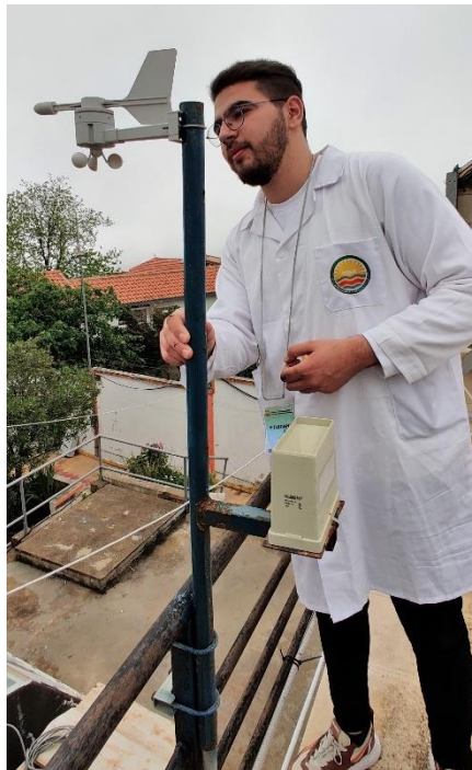
Figure III- 8: La mesure de l'éclairement globale par un pyranomètre de type KYPP et ZONNEN (CMS)
