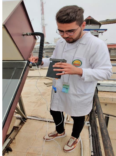
Figure III- 4: mesure de la température à la sortie du capteur.
