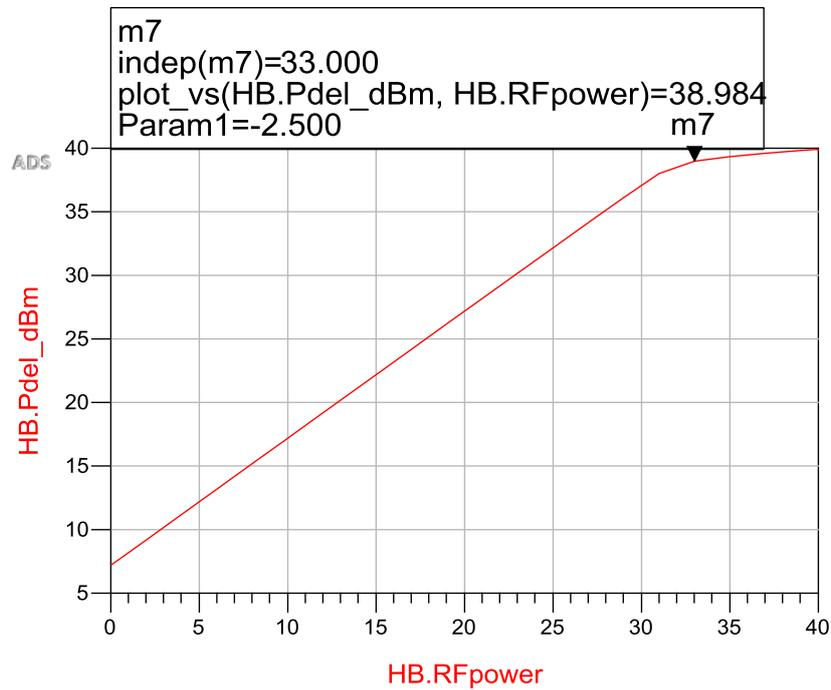
Figure IV.1.a: Puissance de sortie en fonction de P entrée avec des bancs d'essai sans perte.
