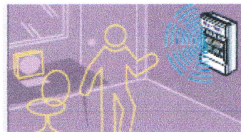
Signalisation sonore et visuelle locale
