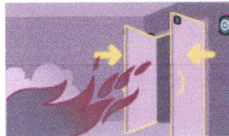
Fermeture des portes coupe-feu grâce aux ventouses électromagnétiques
