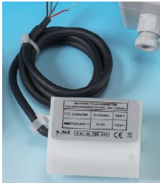
FIG. 2.76 : Transmetteurs de pression utilisée dans la station. source : document descriptif de la station meteo de la part de SKTM.
