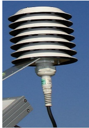
FIG. 2.73 : Thermohygromètre. source : documents descriptifs de la station meteo par SKTM.
