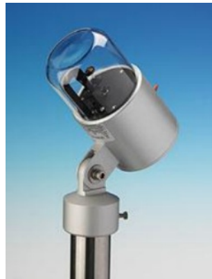
FIG. 2.78 : Instrument mesure radiation directe. source : document descriptif de la station météo de la part de SKTM.
