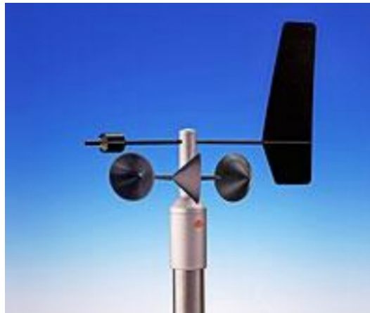
FIG. 2.74 : Anémomètre-girouette. source : documents descriptifs de la station meteo par SKTM.
