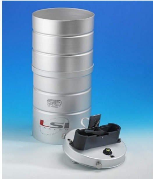
FIG. 2.75 : Pluviomètre en Aluminium. source : document descriptif de la station meteo par SKTM.
