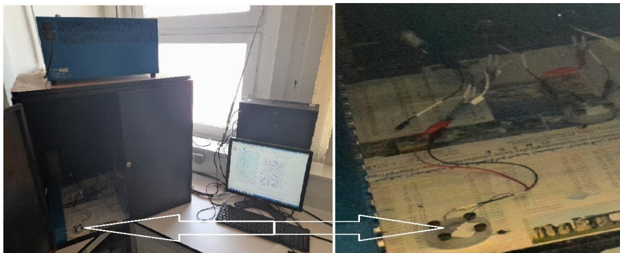
Figure III.3 : Montage de la station électrochimique avec la cellule d'insertion
