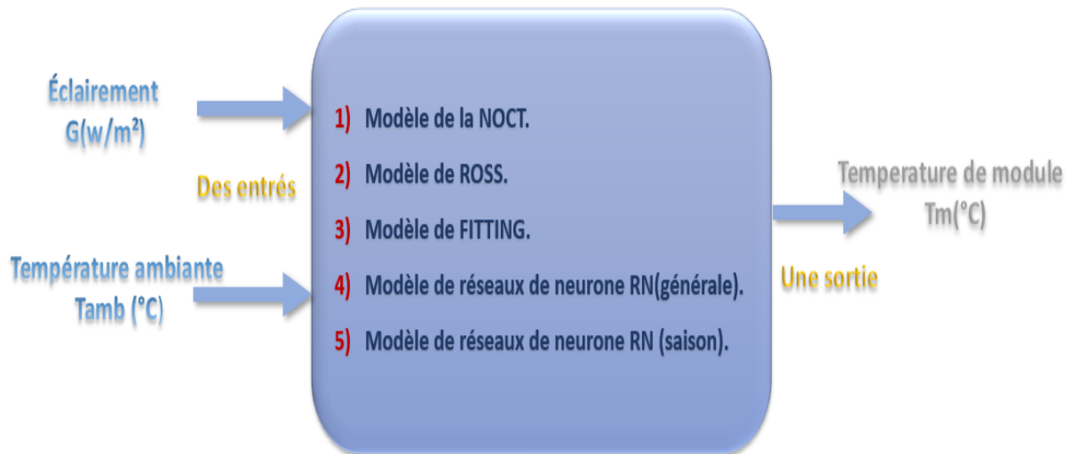
Figure II.07: Schéma modèles utilisés pour la prédiction de la température du module PV.
