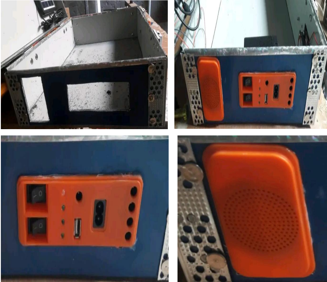
Figure (III-12) : Installation du haut-parleur et du plateau de sortie.
