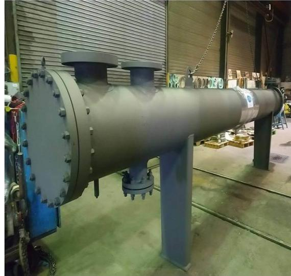
Figure II.2 : échangeur tubulaire : horizontal .
