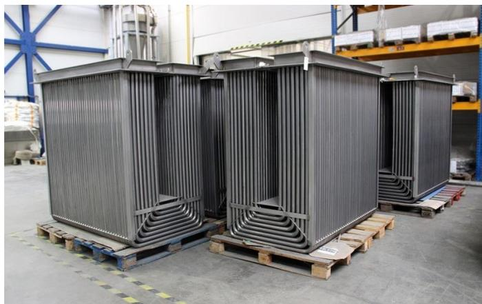
Figure II.1 : échangeur tube en forme u.
